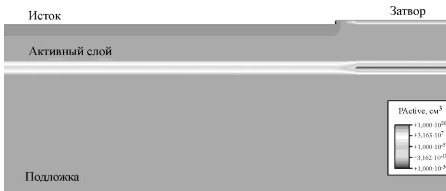
Рис.5. Распределение примеси в сечении полевого элемента Холла КНИ-типа
