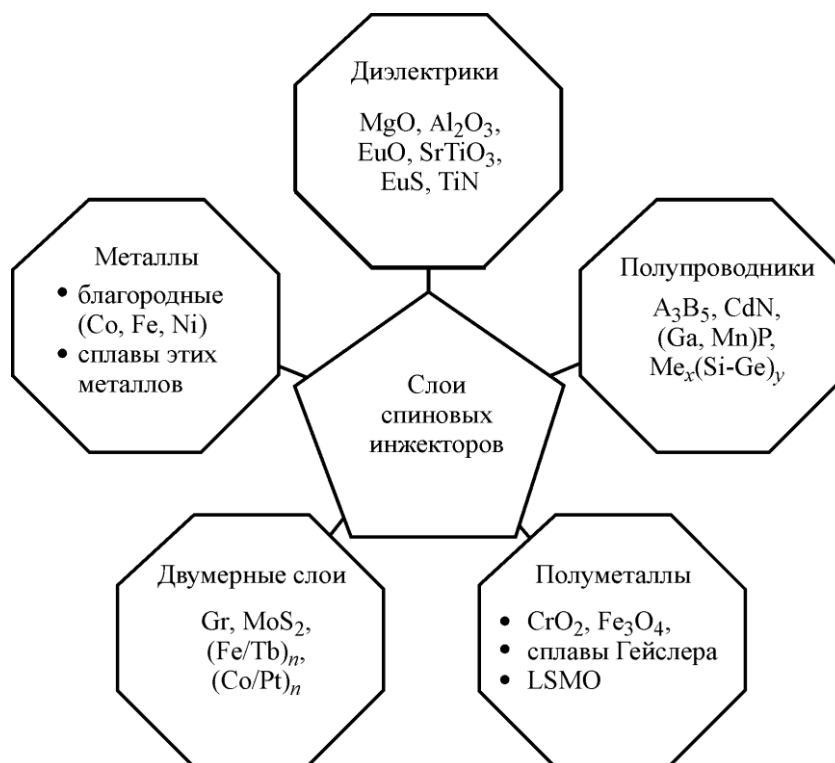
Рис. 3. Типы материалов, использующихся в магнитных туннельных контактах и спиновых инжекторах
