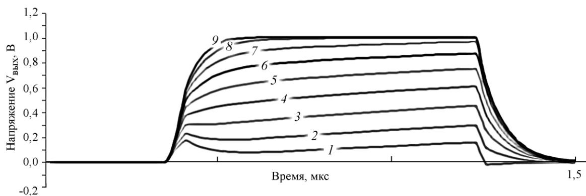
Рис.4. Параметрическое моделирование цепи питания истокового повторителя M2 для определения необходимого напряжения питания (кривые 1–9). Кривая 9 соответствует оптимальному уровню напряжения
