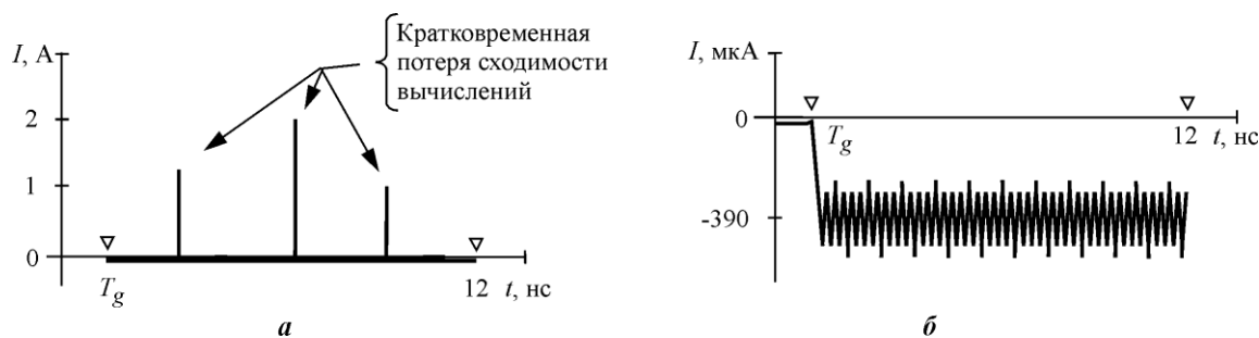
Рис.2. Графики тока потребления: а – неверный результат; б – верный ( T_g – момент включения генерации)
