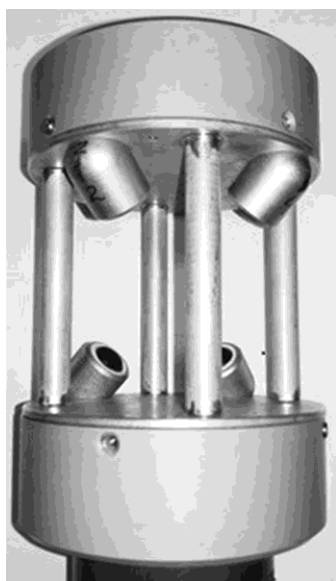
Рис.4. Внешний вид БУЗП с диагональным расположением чувствительных элементов Fig.4. The block of the ultrasonic transducers with a diagonal location of the sensitive elements
