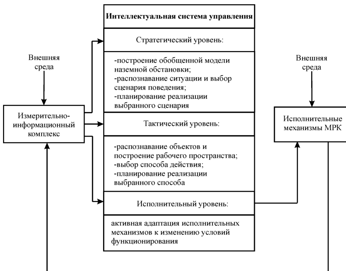
Рис.2. Иерархическая структура ИСУ МРК
