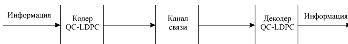
Рис.4. Структурная схема системы помехоустойчивого кодирования на основе QC-LDPC кодов Fig.4. Structural scheme of the quasi-cyclic low-density parity-check codes error correction system
