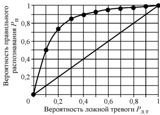
Рис.2. ROC-диаграмма классификатора при различных значениях порога
