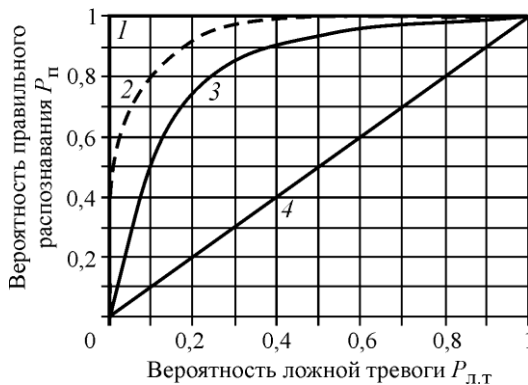
Рис.3. ROC-кривые классификаторов с различными характеристиками качества распознавания (возрастание номеров соответствует ухудшению качества)
