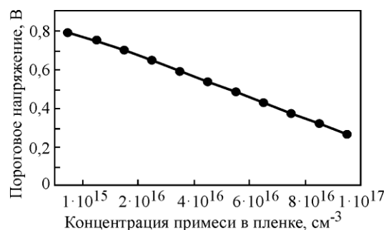
Рис.5. Зависимость порогового напряжения КНИ МОП БПТ от концентрации примеси в пленке Fig.5. The dependence of the threshold voltage SOI MOSFET JLT the impurity concentration in the film
