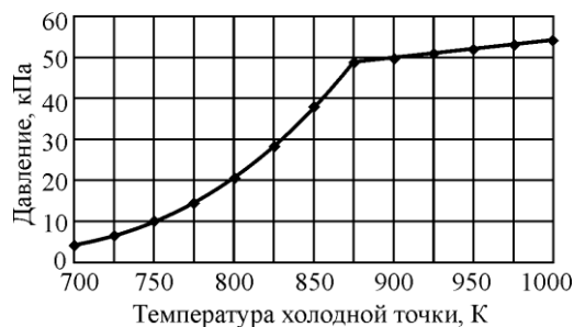
Рис.4. Зависимость давления паров цезия от температуры холодной точки при переходе разряда из насыщенных паров в ненасыщенные ( T = 875 К, m_{Cs} = m_{Hg} = 0,002 г)
