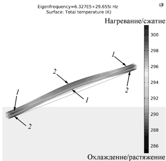
Рис.2. Простая двухфиксированная балка при термоэластичном демпфировании: 1 – горячая часть в результате сжатия; 2 – холодная часть в результате растяжения
